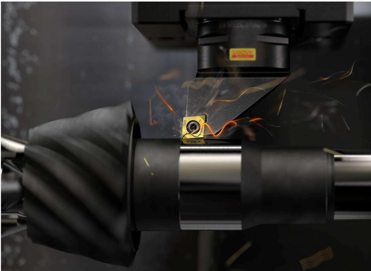
**Подпись к фото:** Точение материалов высокой твердости режущими пластинами из улучшенных сплавов может сократить время обработки и затраты на 70% и более по сравнению с традиционными методами шлифования.
