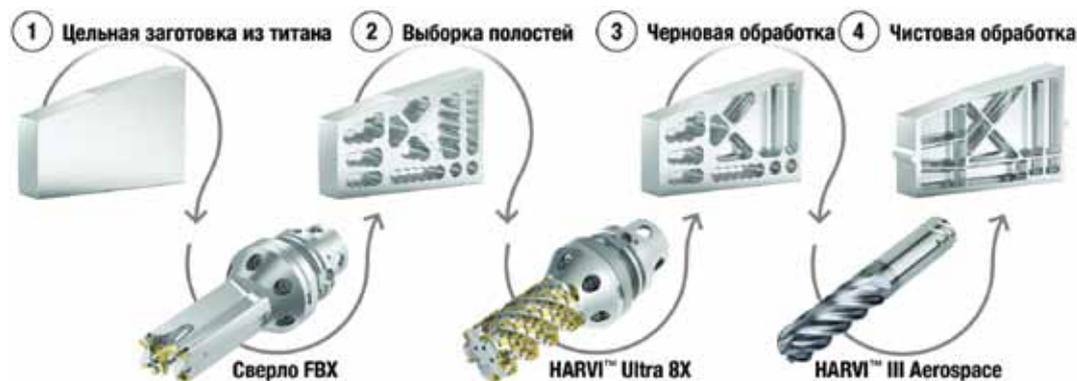
Сверло FBX является частью инструментального трио, специально разработанного для повышения скорости удаления металла и сокращения времени производственного цикла при обработке структурных деталей аэрокосмической отрасли
