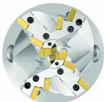
Конструкция сверла FBX обеспечивает направление сил резания вдоль оси инструмента, что минимизирует отжим, повышает стойкость и эффективность удаления металла
