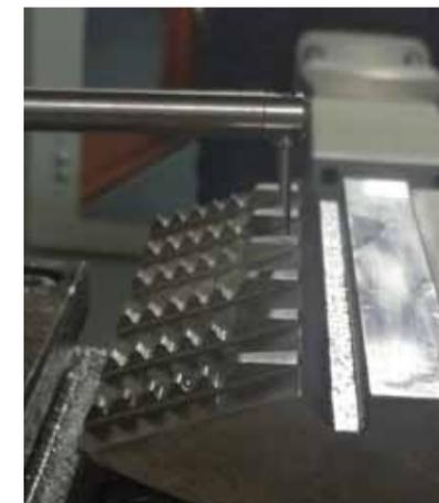
Измерение профиля протяжки контурографом
