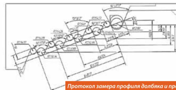
Протокол замера профиля долбляка и протяжки
