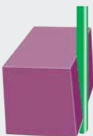
В обычных электроискровых вырезных станках проволочный электрод эродирует по мере продвижения вниз сквозь деталь или по ее поверхности. В любой момент резания проволока-электрод утончается сверху вниз, становясь конусообразной. Более отчетливо это проявляется на деталях большой толщины.
