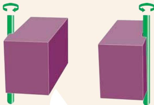
Компьютерное ЧПУ Sodick автоматически анализирует программу резания и определяет направление вращения по оффсету — по часовой или против часовой стрелки.
