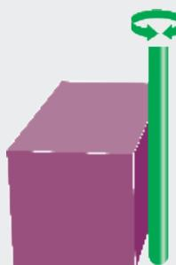
Если проволока вращается, электроискрой «режет» вся поверхность проволоки, включая ту большую часть ее поверхности, которая до сих пор не работала.
