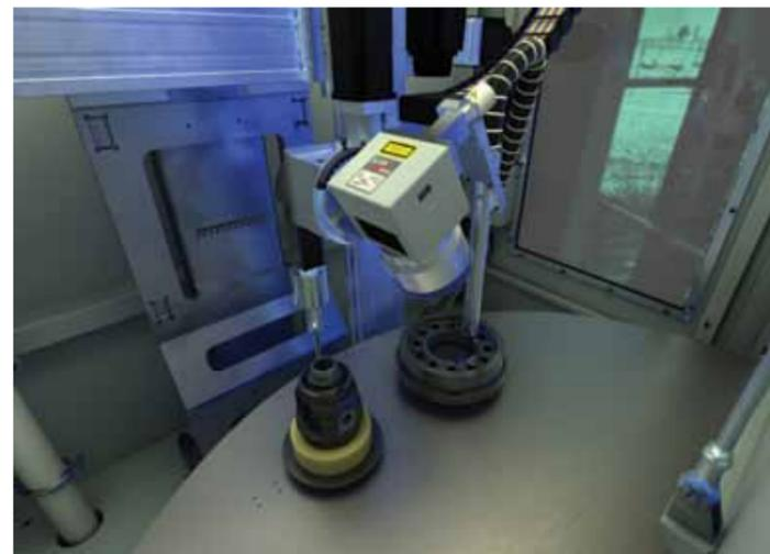
Вид на рабочую зону установки лазерной очистки EMAG LC 4. В процессе очистки удаляются без остатка остатки масла, оксидов, краски или технические покрытия
