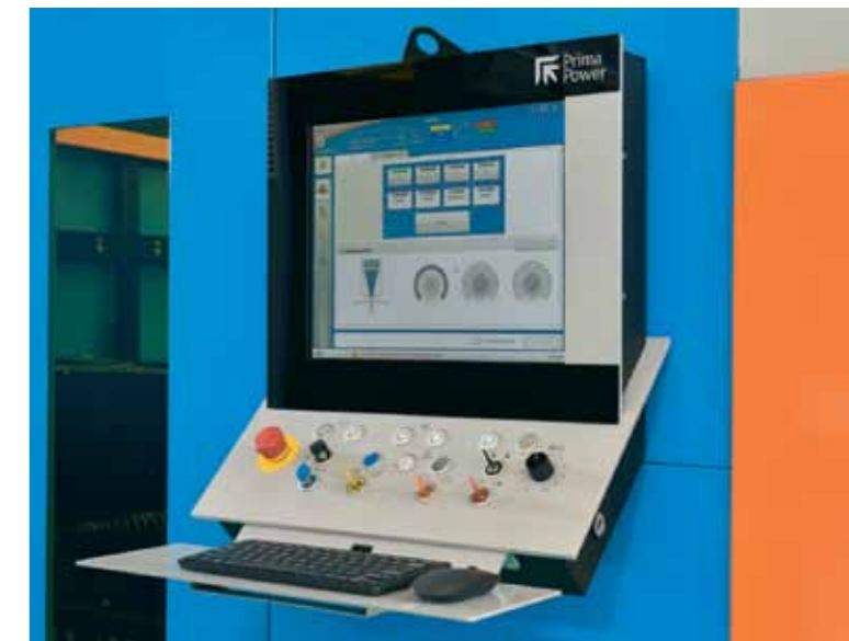
Встроенная система ЧПУ собственного производства Prima Electro Open Laser 2D CNC
