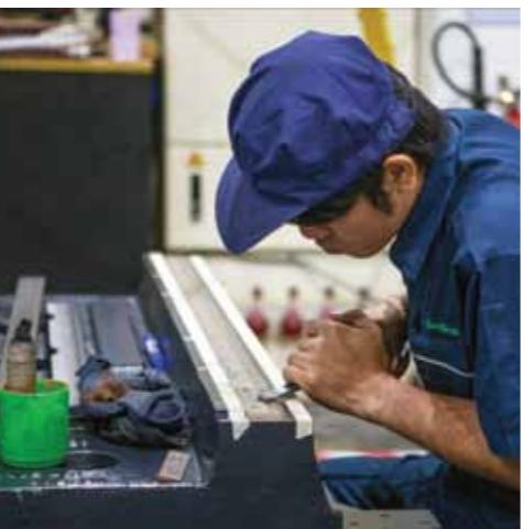
На станкостроительных заводах появились работы, а сами станки оснащаются умными ЧПУ. Но это совсем не означает, что традиционное **РУЧНОЕ ШАБРЕНИЕ** уже можно исключить. Если вы хотите иметь **ДОЛГОЖИВУЩИЙ** станок с многолетней точностью, то **ШАБРЕНИЕ ОБЯЗАТЕЛЬНО!**
