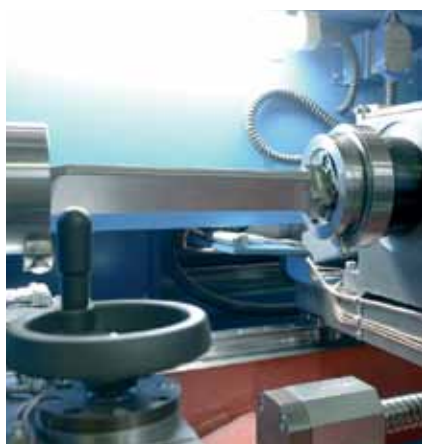
Изделие из титана закрепленное в специальных оправках для быстрой смены заготовок
