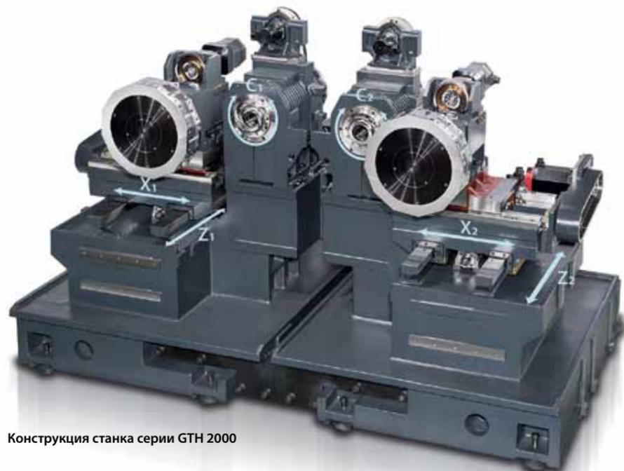
Конструкция станка серии GTN 2000
