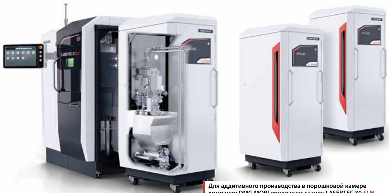
Для аддитивного производства в порошковой камере компания DMG MORI предлагает станок LASERTEC 30 *SLM* 2-го поколения
