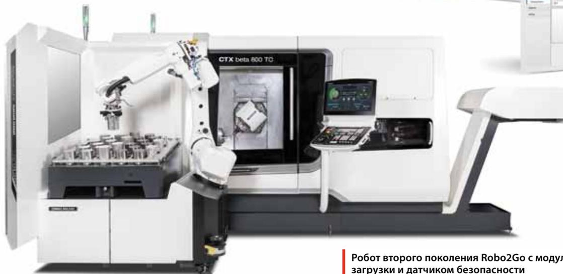
Робот второго поколения Robo2Go с модулем загрузки и датчиком безопасности
