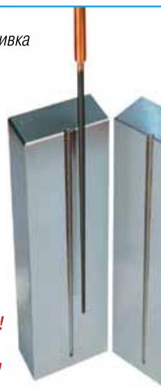
Высокая скорость съема металла обеспечивается не столько быстрой перемещений, сколько фантастической точностью линейных сервоприводов Sodick. Линейные двигатели по командам компьютерного ЧПУ неизменно и стабильно позиционируют электрод так, чтобы обеспечить **ОПТИМАЛЬНЫЙ ЗАЗОР** между электродом и эродируемой поверхностью детали. Причем невероятно точно. Оптимальный зазор - оптимальные условия искрообразования на данных режимах - максимальный съем - наилучшее качество.
