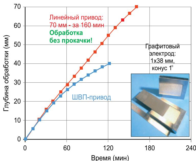
Электроискровая прошивка глубокого отверстия:
