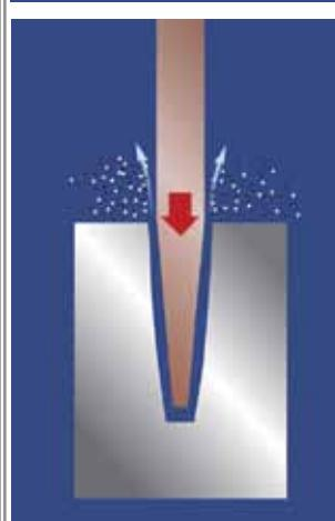
Линейные сервоприводы в ЭИ станках Sodick с мощными планарными линейными двигателями перемещают электрод со скоростью до **600 мм/сек** и ускорением до **2,0G**!
