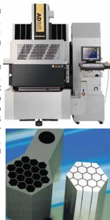
В ЭИ прошивных станках **не-Содик** с инертными и тихоходными ШВП-приводами струйная прокачка — всегда опасность **БРАКА** вследствие неполной эвакуации шлама!
