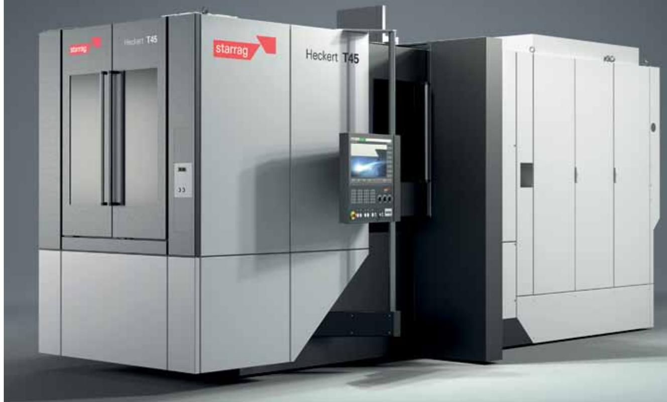
На выставке AMB 2018 в Штутгарте компания Starrag впервые представила совершенно новый многофункциональный обрабатывающий центр Heckert T45. Отличительные признаки: сверхкомпактная, в то же время надежная конструкция станка и поворотно-наклоняемое устройство с палетой 400, специально сконструированной для токарных операций; жесткий шпиндель HSK-T100 для съема большого объема стружки. Обрабатывающий центр Heckert T45 создан для продуктивной комплексной обработки в широкой области приложений.
