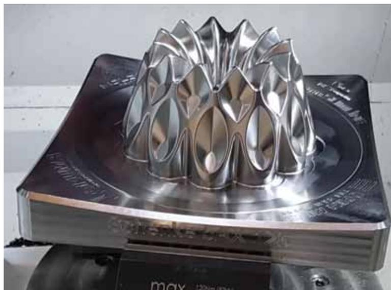
ционно нашли применение интеллектуальные технологии OKUMA, такие как *Machining Navi* для снижения вибраций при обработке или система 5-осевой автокоррекции для компенсации геометрических погрешностей, которые дополнительно также повышают точность станка. В результате *GENOS M460V-5AX* достигает точности позиционирования 2 мкм по осям X, Y и Z.
