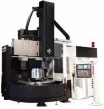
Станок представляет собой комбинацию функциональности и компактности. При небольших габаритах станок имеет возможность осуществлять токарные работы, фрезеровку, сверление отверстий, а при необходимости оснащаться шлифовальным приспособлением.
