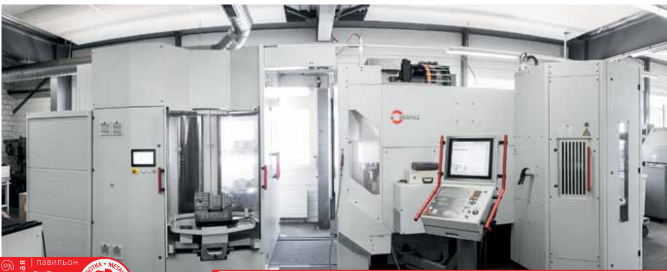
5-осевой обрабатывающий центр C 22 U с расположенным слева устройством смены палет PW 150; система содержит общим числом 11 сменных палет 320x320 мм и/или 400x320 мм; спереди слева находится станция оснастки палет
