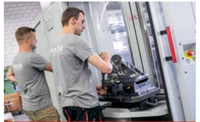
Удобная для оператора станция оснастки устройства смены палет PW 150
