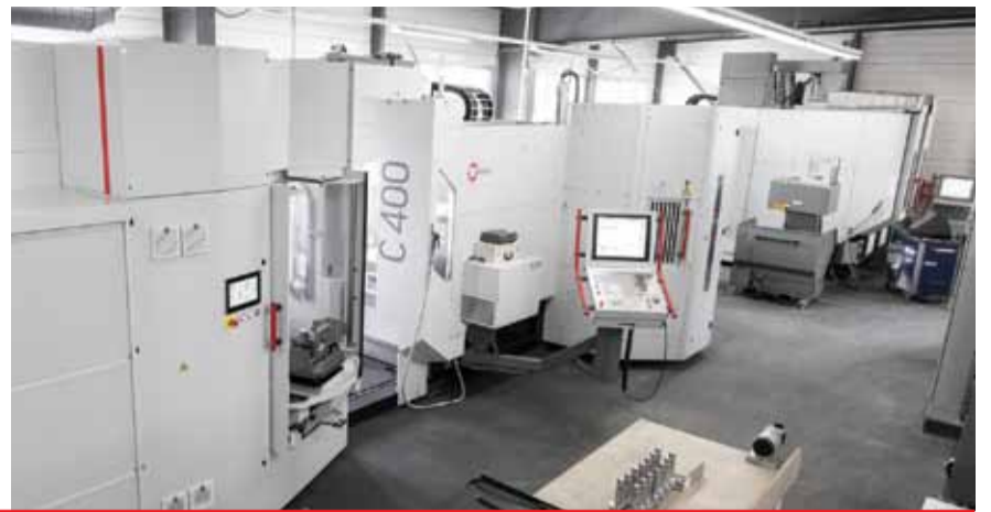
На рисунке частично показан «бульвар Hermlle» на фирме Feusi AG с 5-осевым обрабатывающим центром C 400 U, оснащенным магазином заготовок, 5-осевым обрабатывающим центром C 22 U с устройством смены палет PW 150 и 5-осевым обрабатывающим центром C 42 U/MT с функцией вращения
