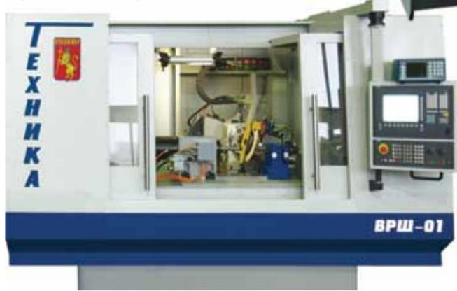
Освоено производство резбошлифовальных станков с высотами центров 125 и 175 мм. Станки имеют возможность обработки наружных и внутренних резьб – метрических, полукруглых, круглых, упорных, трапецеидальных, дюймовых и конических. Обработка деталей может производиться в центрах с использованием поводков и планшайбы, трехкулачковом, магнитном или цанговом патронах при необходимости с использованием люнета. При обработке внутренних резьб имеется возможность подачи СОЖ через шпиндель бабки изделия.
