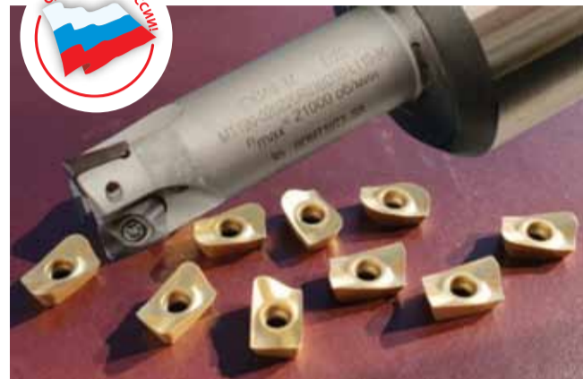
Концевая фреза СКИФ-М диаметром 20 мм и сменные пластины с 9-ю различными радиусами для этой фрезы
