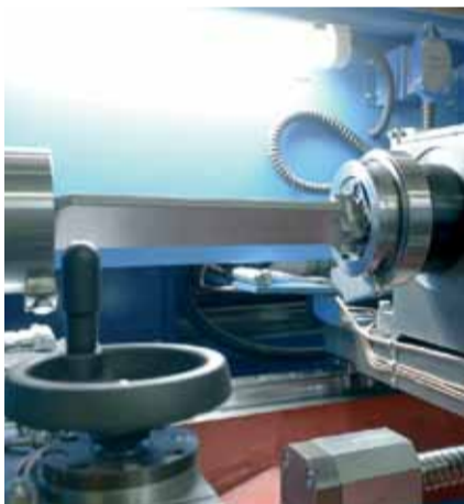
Изделие из титана закрепленное в специальных оправках для быстрой смены заготовок
