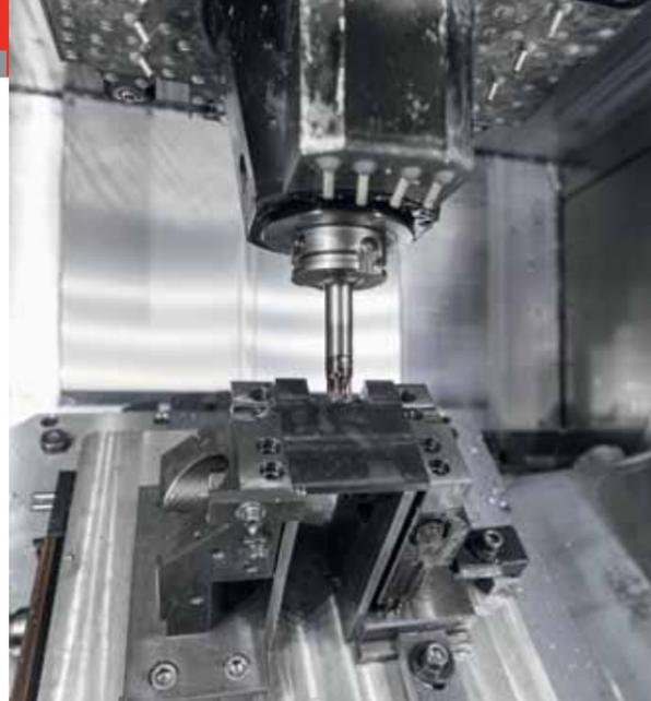
Рабочая зона 5-осевого высокопроизводительного обрабатывающего центра C 42 U с ЧПУ, наклонно-поворотным столом диаметром 800×630 мм и закрепленным на палете зажимным устройством для 5-осевой обработки заготовки
