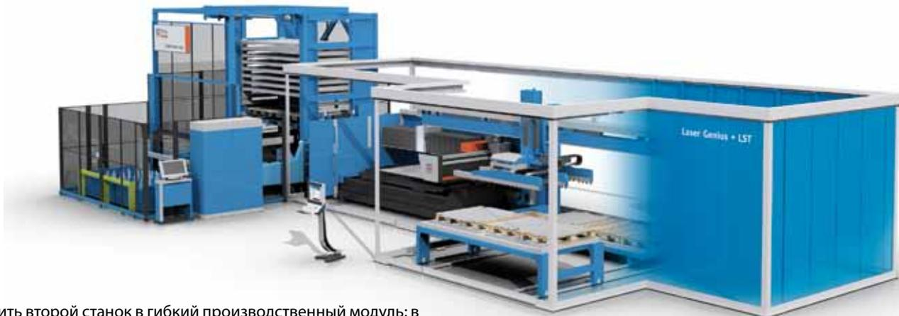
единить второй станок в гибкий производственный модуль; в зависимости от требуемых операций обработки и используемой технологии в качестве второго станка для системы может быть выбран любой станок из модельного ряда **Prima Power** для пробивки, лазерной резки, комбинированной пробивки с резкой ножницами и комбинированной пробивки с лазерной резкой.
