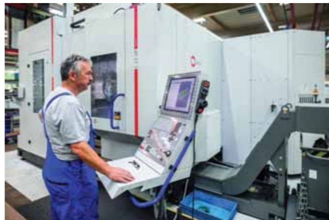
Оператор станка Гюнтер Шульц стоит перед 5-осевым ОЦ C 22 UP Hermle в цеху по производству инструментов и форм компании WMF Group GmbH
