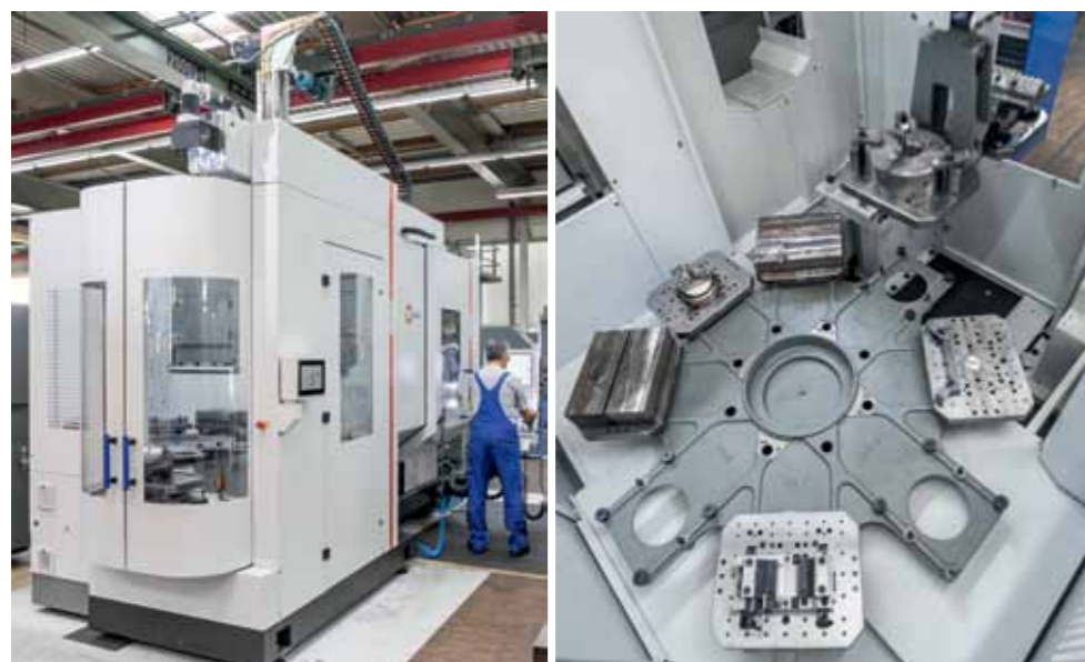
Устройство смены палет PW 150 для обрабатывающего центра C 22 UP: слева ) поворотная станция оснастки для загрузки палет, крепления заготовок и съема готовых изделий; справа ) восемь палет в магазине + две палеты в сменном механизме и одной палетой в станке
