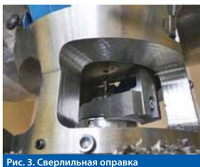
Рис. 3. Сверлильная оправка
