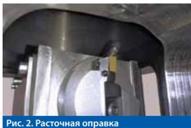
Рис. 2. Расточная оправка
