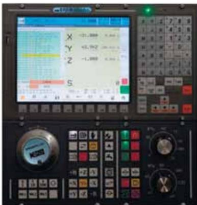
УЧПУ «ГАММА+ 5Е» предоставляет следующие возможности: до 16 управляемых осей (из них до 8 шпиндельных); 5-и осевая интерполяция; 3 независимых канала управления; линейные, круговые, винтовые, векторные интерполяции; преобразование осей и координат, компенсация люфта и погрешности ходовых винтов; перезапуск программы обработки с указанного места после останова, так называемый Restart From Interruption; безударные разгон и торможение; количество входов/выходов до 2048.
