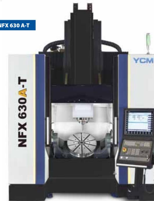
Сочетание высокооборотного и мощного шпинделя (15 000 мин<sup>-1</sup>, 26 кВт), отличной динамики (ускорение до 1G, рабочие подачи до 30 м/мин) и дополнительной возможности токарной обработки делают этот станок эффективным и высокопроизводительным инструментом для решения задач комплексной обработки деталей сложных форм.
