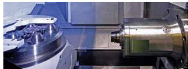
Для сердца станка – шпинделя – также имеются многочисленные варианты исполнения. Заказчик может выбирать между универсальными шпинделями HSK-63, высокоскоростными шпинделями для динамической резки алюминия и высокомоментными шпинделями HSK-100, которые могут потребоваться, например, для обработки титана. Какой бы шпиндель ни выбрал заказчик, это будет продукт собственного производства компании Starrag.
