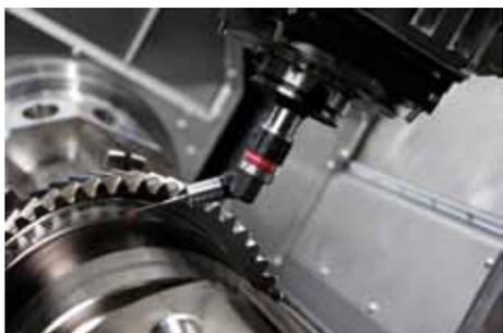
параметров инструмента, щупы для сканирования поверхности детали (технологии DIGILOG), а также датчики касания для обмера обрабатываемой детали.
