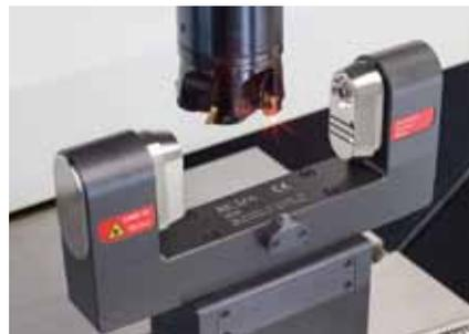
го процесса, нутромеры для серийного производства и, разумеется, измерение инструмента лазерными системами. Лазерная скоба нового поколения позволяет пользоваться преимуществами сразу 2-х технологий: NT, использующей цифровую передачу, и DIGILOG, использующей аналоговую передачу сигнала
