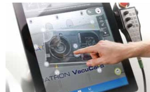
На третьем этапе оператор производит привязку к детали с помощью камеры и автоматического измерительного щупа.
