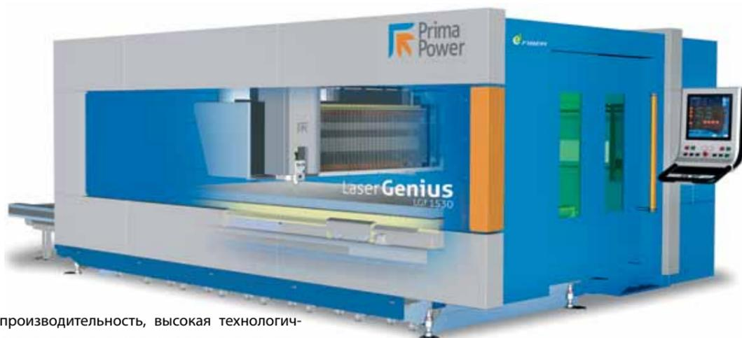
Впечатляющая производительность, высокая технологичность, энергоэффективность – только гению под силу создать подобный шедевр! Новая установка 2D лазерной резки Laser Genius с волоконным лазером от Prima Power имеет выдающиеся характеристики динамичности, точности и эффективности благодаря применению синтетического гранита для станины и карбонового волокна для каретки. Это позволяет обеспечить скорость резки до 280 м/мин. и достигнуть ускорения до 2,4 g.
