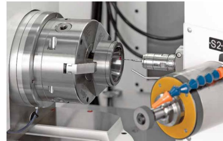
Новый высокоскоростной шлифовальный шпиндель обеспечивает скорость обработки до 140 м/с
