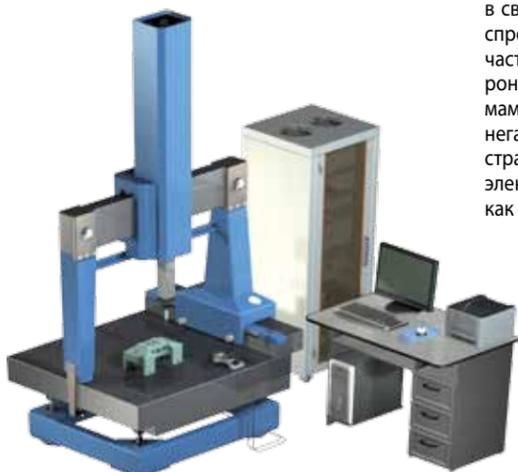
Координатно-измерительная машина БВ-2050 с пределами измерения 600×600×500 мм
