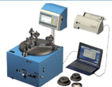
Прибор мод. БВ-7661 для контроля осевого зазора подшипников
