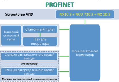
Для подключения периферийных устройств используются станции распределенного ввода/вывода ET200M (шкаф) и PP 72/48 (магазин). Станочный пульт – MCR 483C PN; ОП – OP015AT TCU, 15 дюймов; кнопочная ВСП – HT2 С ДИСПЛЕЕМ.
