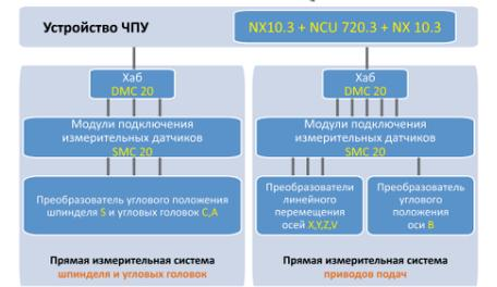
В качестве прямой измерительной системы шпинделя S выбран энкодер *ЛИР 250* фирмы *СКБ ИС* (Россия), угловые головок C, A – энкодер серии *SP*, фирмы *Fagor*.
