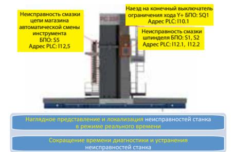
В случае появления информационного сообщения, или возникновения неисправности какого-либо узла/аппарата, данный узел/аппарат выделяется на соответствующем виде станка, и появляется краткое описание возникшего события. По нажатию, на экран выводятся полное описание и способ устранения данного события/неисправности.
