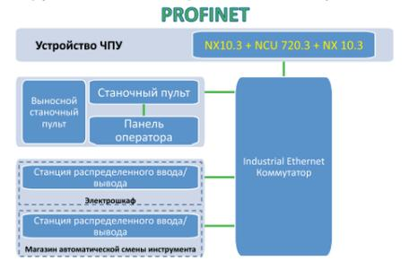
Для подключения периферийных устройств используются станции распределенного ввода/вывода *ET200M* (шкаф) и *PP 72/48* (магазин). Станочный пульт – *MCP 483C PN*; ОП – *OP015AT TCU*, 15 дюймов; кнопочная ВСП – *HT2 С ДИСПЛЕЕМ*.
