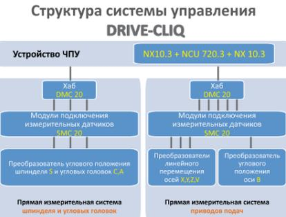
В качестве прямой измерительной системы шпинделя S выбран энкодер ЛИР 250 фирмы СКБ ИС (Россия), угловые головок C, A – энкодер серии SP, фирмы Fagor.
