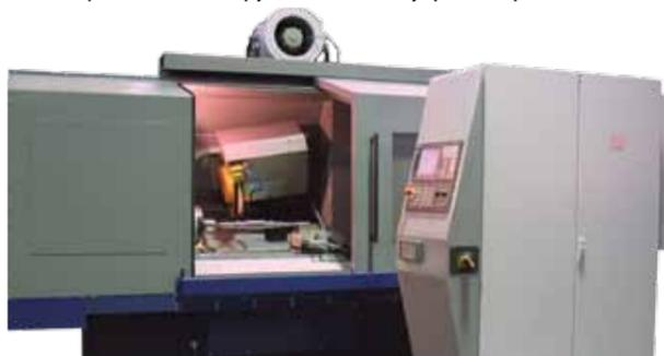
Резьбошлифовальный станок модели МШ520М
