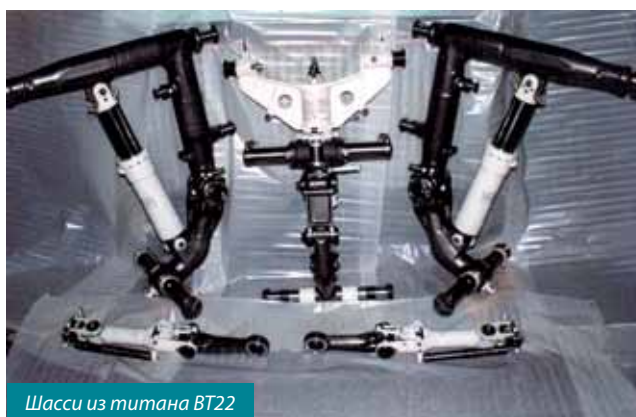
Шасси из титана BT22 Результаты испытаний инструмента ChaseMold при обработке титана BT22
