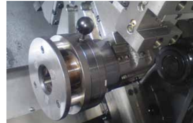
Резьбонакатная головка в револьвере станка ATM
