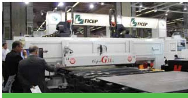
Наличие вспомогательной оси сверлильной головки и системы фиксации листа перед обработкой в определенной позиции позволяет выполнять все механические операции (сверление, фрезерование, разметка, нарезание резьбы, зенковка) в зоне вспомогательного перемещения длиной 400 мм, гарантируя очень высокую точность обработки.
