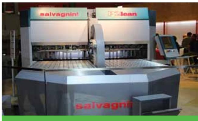
Панелегибы SALVAGNINI предназначены для автоматического изготовления панелей из металлических листов, гибка которых осуществляется универсальными гибочными инструментами. За счет множества запатентованных технологий и конструктивных особенностей панелегиб SALVAGNINI P2lean существенно расширяет спектр производственных возможностей в сравнении с вертикальным гибочным прес-
