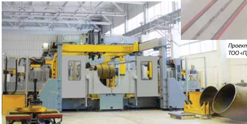
Специальный станок производства СТАНЭКСИМ для механической обработки штампосварных деталей трубопроводов (ШСДТ)
