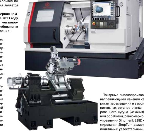
Токарные высокопроизводительные обрабатывающие центры с направляющими качения серии 1ТНК обеспечивают высокие скорости перемещения и высокую точность позиционирования исполнительных органов станка. Цельнолитое основание из модифицированного чугуна (механит) обеспечивает основу для высокоточной обработки, равномерно распределяя и гася вибрацию. Система управления Sinumerik 828D от компании Сименс с языком программирования ShopTurn делает процесс программирования простым,
