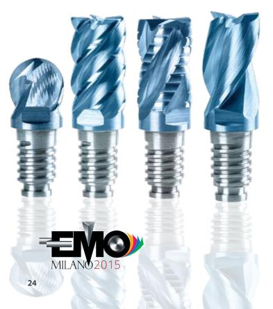
Линейка твердосплавных концевых фрез Power Mill включает в себя фрезы диаметром от 2 до 20 мм с различной геометрией режущей кромки (фаска, радиус, острая режущая кромка). Точно отбалансированные фрезы стандартно оснащены системой защиты против вытягивания инструмента Safe-Lock. Фрезы предназначены для обработки широкого диапазона материалов: разнообразные стальные сплавы,
