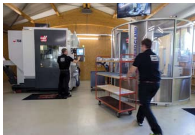
Один из двух 5-осевых универсальных обрабатывающих центров Haas UMC-750 компании оборудован автоматической системой загрузки для непрерывной работы
