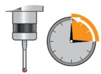
предусмотрен процесс калибровки, повышающий повторяемость датчика при различных направлениях касания и точность его позиционирования при многоосевых векторных перемещениях.
