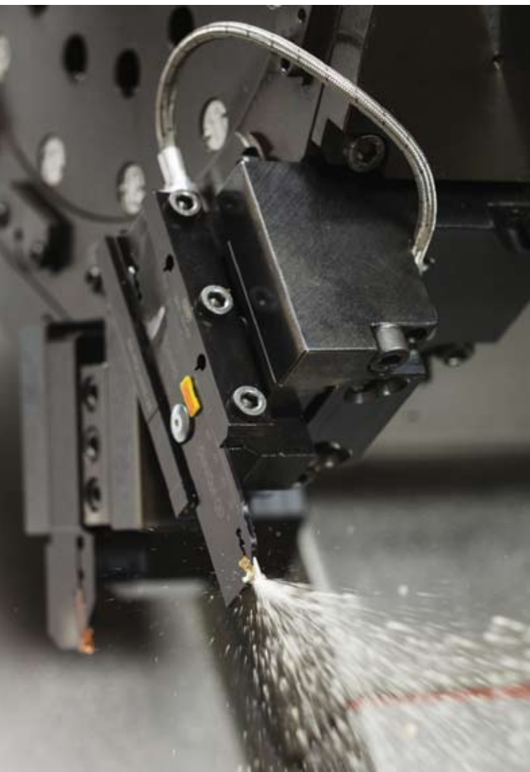
Рис. 1. CoroCut QD для отрезки и обработки канавок с высокоточным нижним и верхним подводом СОЖ
