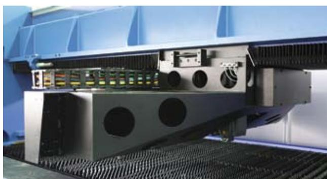
мощности излучения. Самая высокая плотность мощности находится в фокальной точке. Фокальную точку можно расположить на верхней поверхности, под верхней поверхностью заготовки где-то в глубине или на нижней поверхности заготовки, все это влияет на ширину реза, качество и скорость резания.
