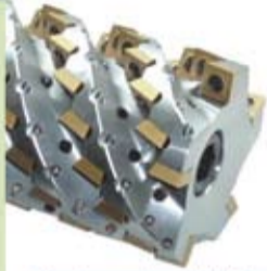
Моноблочная фреза СКИФ-М диаметром 80 мм с соплами для подачи СОЖ под давлением
