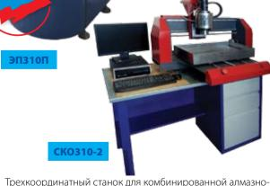
ультразвуковой обработки неметаллических материалов СКО310-2. Станок оснащен современной ультразвуковой головкой с вращающимся алмазным инструментом, позволяющей получать отверстия (от 0,5 до 20 мм) и пазы в деталях из нетокопроводящих материалов, а также композиционных, углерод-углеродных и углеродсилицидных керметов.
