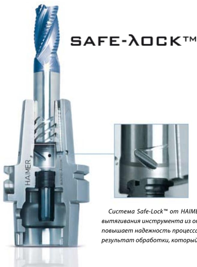
*Система Safe-Lock™ от HAIMER представляет собой интегрированную систему защиты против вытягивания инструмента из оправки, благодаря фрикционному и геометрическому замыканию. Это повышает надежность процесса, позволяет достигать более высокий объем резания и гарантирует результат обработки, который в разы лучше, чем при применении традиционных креплений.*
