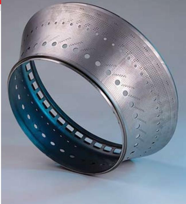
Рис. 5. Компоненты турбины, подобные изображенному на рисунке, должны иметь отверстия для охлаждения. С помощью установок Laserdyne можно просверлить данные отверстия в жаропрочных материалах на высокой скорости с высокой точностью.
