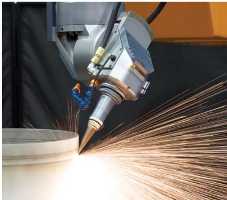
Рис. 4. Новейшее приобретение компании Hi-Tek – установка резки волоконным лазером LASERDYNE 795XL способна выполнять обработку с погрешностью расхода воздуха при изготовлении компонентов двигателей нового поколения для аэрокосмической промышленности в пределах  $\pm 2\%$ , в то время как нормой считается погрешность  $\pm 10\%$ .
