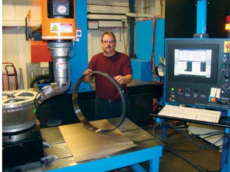
Рис. 3. На фотографии изображен управляющий производством Скотт Станг (Scott Stang) с компонентом двигателя для аэрокосмической промышленности, обработанным на недавно приобретенной установке лазерной резки Laserdyne 795XL Beam Director. Изображенная на фотографии установка оснащена поворотным столом, благодаря чему возможно сверление отверстий для динамического охлаждения под различными углами на высокой скорости и с высокой точностью.
