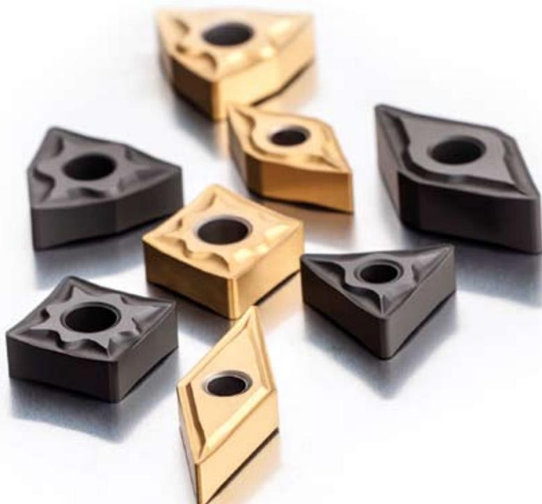
Двусторонние сменные режущие пластины имеют позитивный стружколом и зачистную кромку **Wiper** новой формы, что позволяет добиться низких значений шероховатости обработанной поверхности при токарной обработке. Это позволяет увеличить подачу в 2 раза, при этом производительность возрастает и сохраняется низкое значение шероховатости
