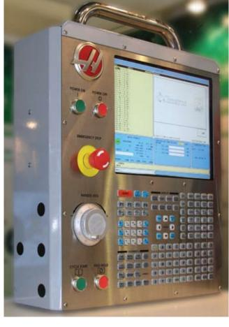
управления в качестве опции. Несмотря на то, что система управления является закрытой, применение контроля согласно стандарту ISO в Haas дает нам такое преимущество, как возможность подключения дополнительного оборудования – например, устройств смены паллет или роботов.
