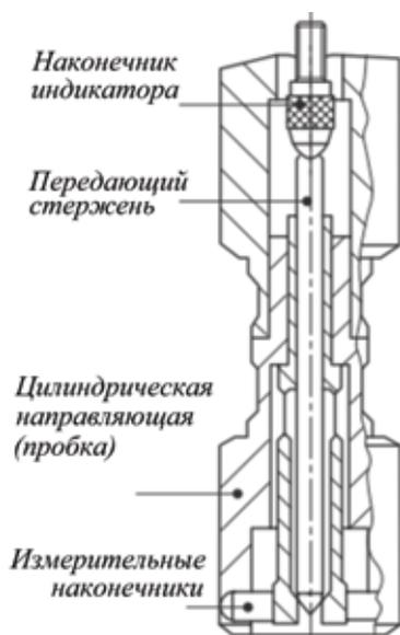
Рис. 2. Конструкция нутромера
