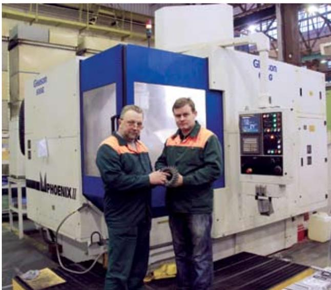
*Оператор станков завода «Красный Октябрь» и ведущий специалист по коническим зубчатым колесам Даниил Морозов рядом с одним из двух новых зубошлифовальных станков Gleason Phoenix® II 600G для конических зубчатых колес. Третий станок 600G будет поставлен позднее в этом году вместе с двумя зуборезными станками Gleason Phoenix® II 600HC для конических ЗК, контрольно-обкатной машиной 360T и точным станком для резцовых головок NCG-205*
