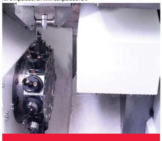
После окончательной обработки, например, Т-образного хвостовика (фото 3) перемещаемый шпиндель со стандартным двухкулачковым патроном перемещает деталь в поворотную позицию. 2-штифтовый параллельный захват поворотной станции зажимает деталь и затем зажимное приспособление на главном шпинделе отпускает деталь. После поворота (фото 4) патрон снова забирает деталь и шпиндель перемещается к 12-позиционной инструментальной револьверной головке на обработку следующего Т-образного хвостовика.
